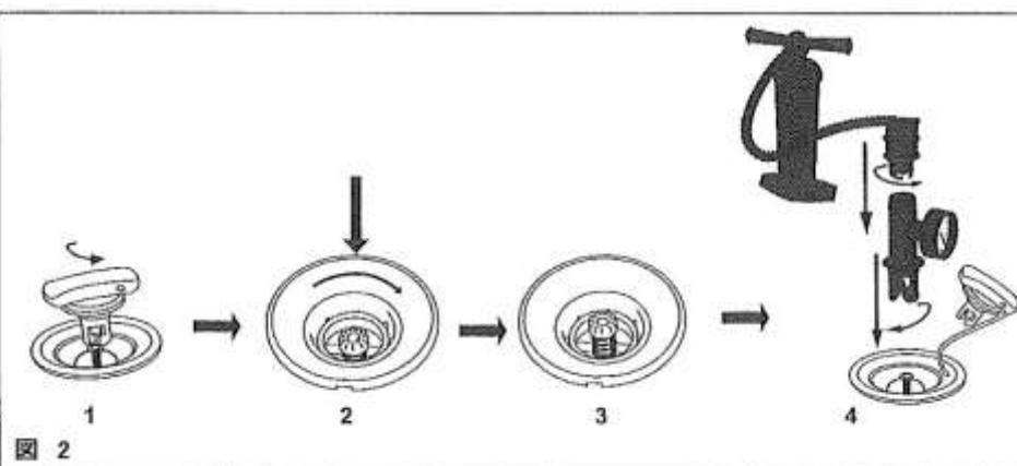
4. カヤックを使用する前に、空気が漏れていないかエアーバルブを必ず注意深くチェックして下さい。
